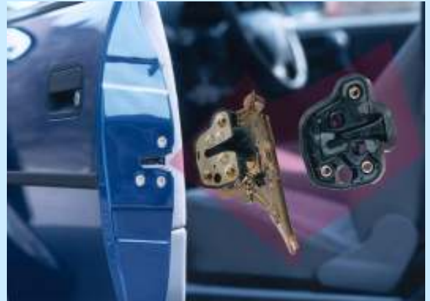
ドアロック部材 Door-lock parts VESTORAN/SBR VESTAMID/X-NBR
